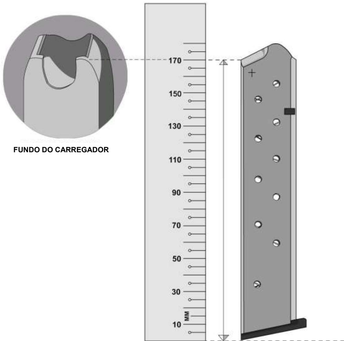
O carregador é colocado verticalmente em pé sobre uma superfície plana, com a medição feita da superfície plana para cima até a parte traseira dos lábios de alimentação, conforme ilustrado. Somente carregadores retos e rígidos são permitidos (ou seja, flexíveis, de tambor, "J", "L", "T" ou de formato semelhante são proibidos).
