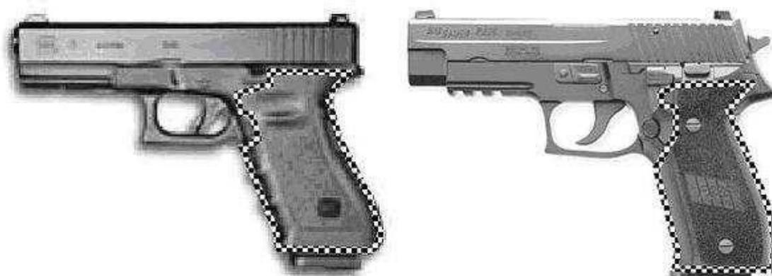
A fita só pode ser aplicada nas áreas indicadas pelas linhas pontilhadas, o que inclui as seções frontal e traseira da empunhadura. No entanto, a fita não pode ser usada para desativar a trava de segurança da empunhadura, nem pode ser aplicada a qualquer parte do ferrolho, gatilho, guarda-mato ou em qualquer alavanca ou botão.
