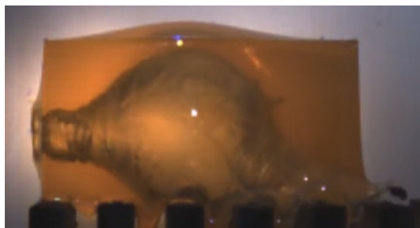
Fig 2 - Munição 5,56 X 45 mm SS109 - efeitos em gelatina balística, observáveis imediatamente após transfixação. Fonte: https://www.youtube.com/watch?v=HRbAfdU9vY .
